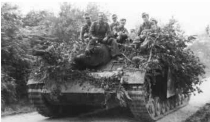
redoutable canon de 88 mm est monté sur un châssis de *Panther*. Le char obtenu se distingue par une silhouette très basse et une large casemate à pans inclinés augmentant l'efficacité du blindage.
